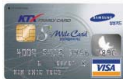
■ Un exemple de carte EMV multiapplication lancée en octobre 2004 en Corée. Elle permet, outre ses fonctions de paiement classiques, d'acheter des titres de transports pour le TGV coréen Korail, et peut être utilisée comme carte d'accès au train.
