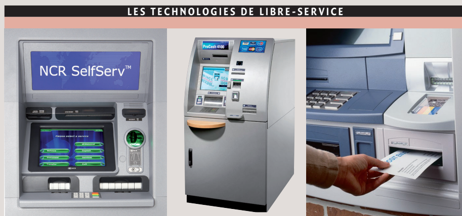
Le dépôt simple ou valorisé, et le recyclage des espèces permettent une optimisation de l'encaisse dormante, des transports de fonds et de la disponibilité (de gauche à droite: NCR SelfServ34, Wincor ProCash 4100, et Diebold Opteva 328).
